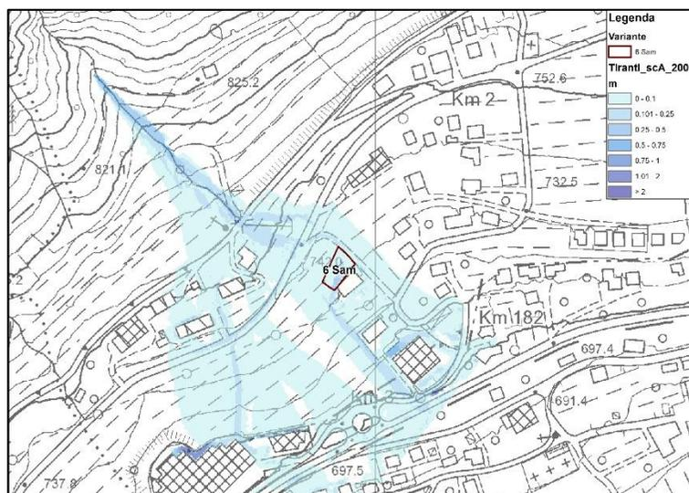
Figura 4.2 – Massimo tirante della corrente simulato (m) – TR200 anni ScA [6]
