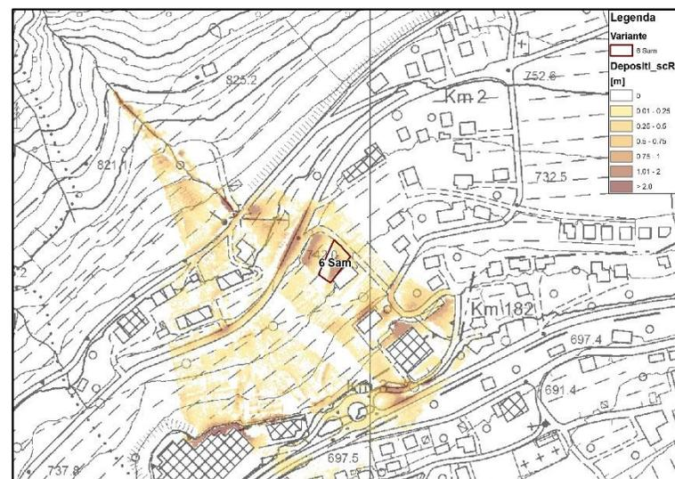
Figura 4.13 – Massimi depositi (m) – TR200 anni ScR [6]
