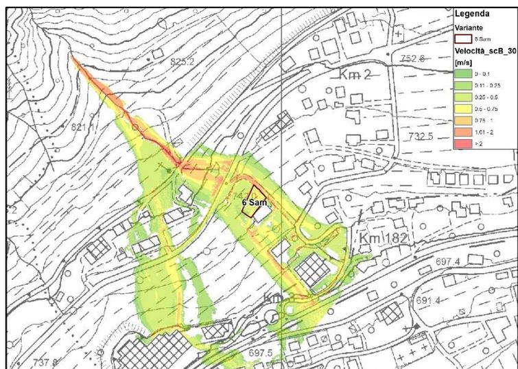
Figura 4.6 – Massima velocità della corrente simulato (m/s) – TR30 anni ScB [6]
