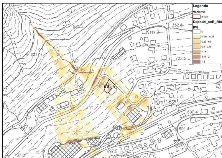
Figura 4.10 – Massimi depositi (m) – TR200 anni ScB [6]
