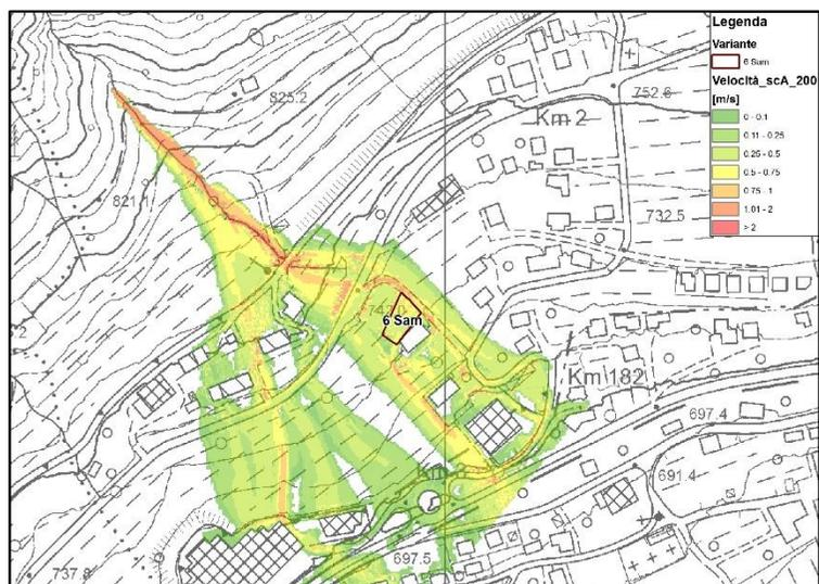
Figura 4.3 – Massima velocità della corrente simulato (m/s) – TR200 anni ScA[6]
