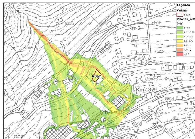
Figura 4.12 – Massima velocità della corrente simulato (m/s) – TR200 anni ScR [6]
