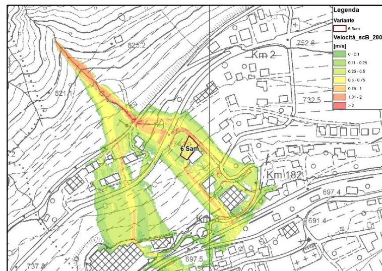
Figura 4.9 – Massima velocità della corrente simulato (m/s) – TR200 anni ScB [6]
