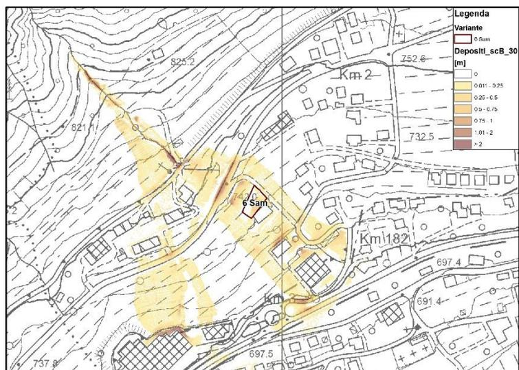
Figura 4.7 – Massimi depositi (m) – TR30 anni ScB[6]
