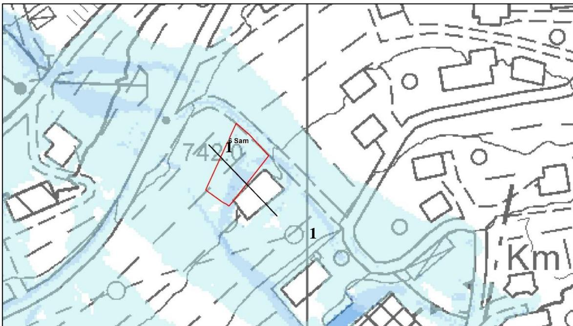
**Figura 4.18 –massimi tiranti (m) in corrispondenza della variante 6 Sam – TR200 anni ScR, con posizione della sezione 1**
